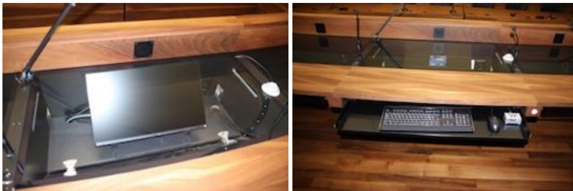
Figure 10: poste de travail dans une salle d'audience du Tribunal cantonal de Zurich - encastré dans le mobilier
